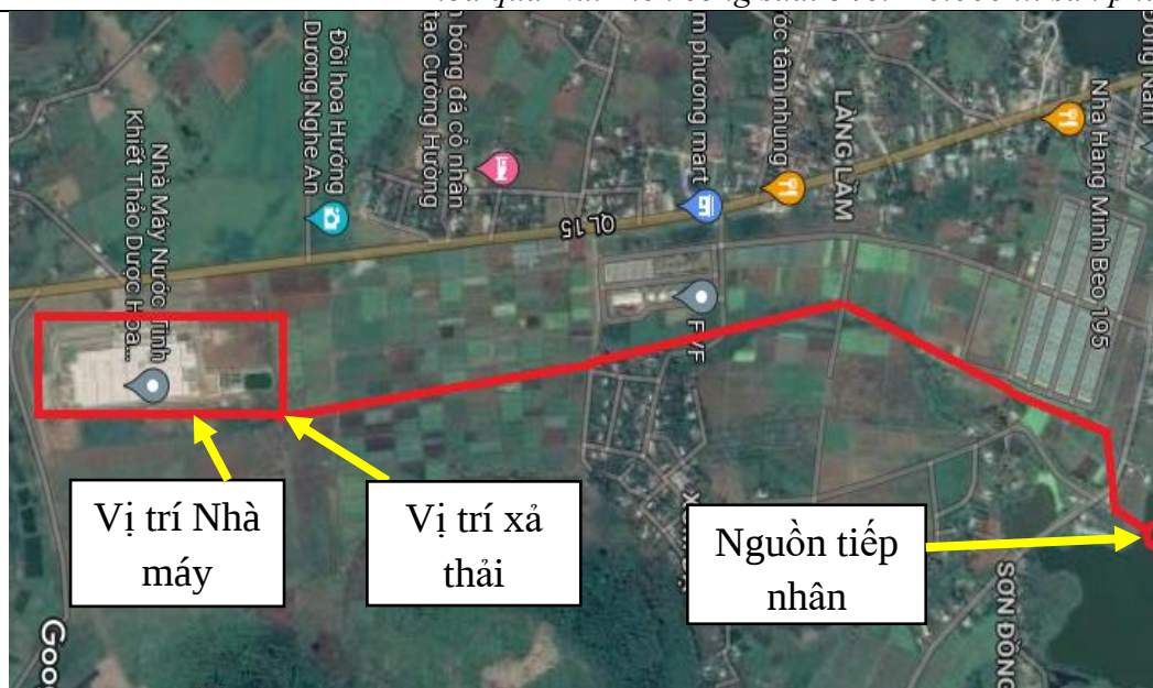
Hình 3.5. Hệ thống thoát nước thải sau xử lý của nhà máy ra hồ Sông Sao
